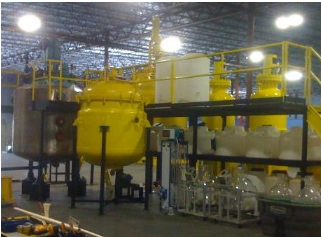
Рис. 9. Производственный участок для извлечения платины, родия и палладия из отработанных автомобильных катализаторов дожигания выхлопных газов на основе технологии электрогидрохлорирования. Производительность участка по платине – 1,0 - 1,2 кг/день. Майями, 2005 г.
