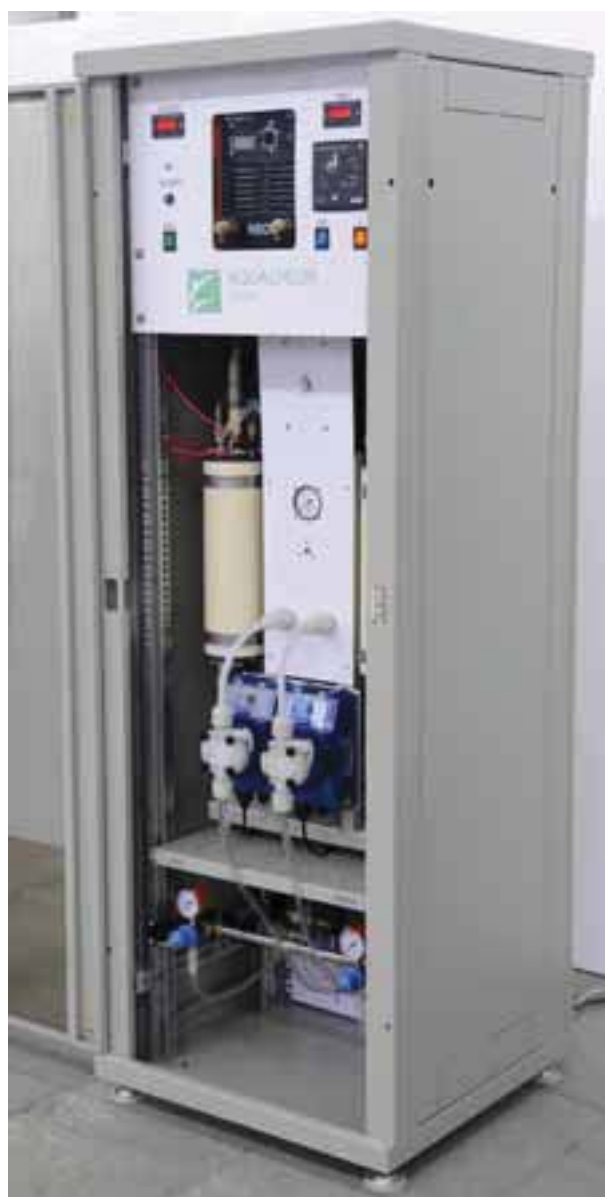
Рис. 6. Установка АКВАХЛОР-500М с реакторами МБ-26-100, работающими в режиме самоочистки. Разработка 2011 года.
