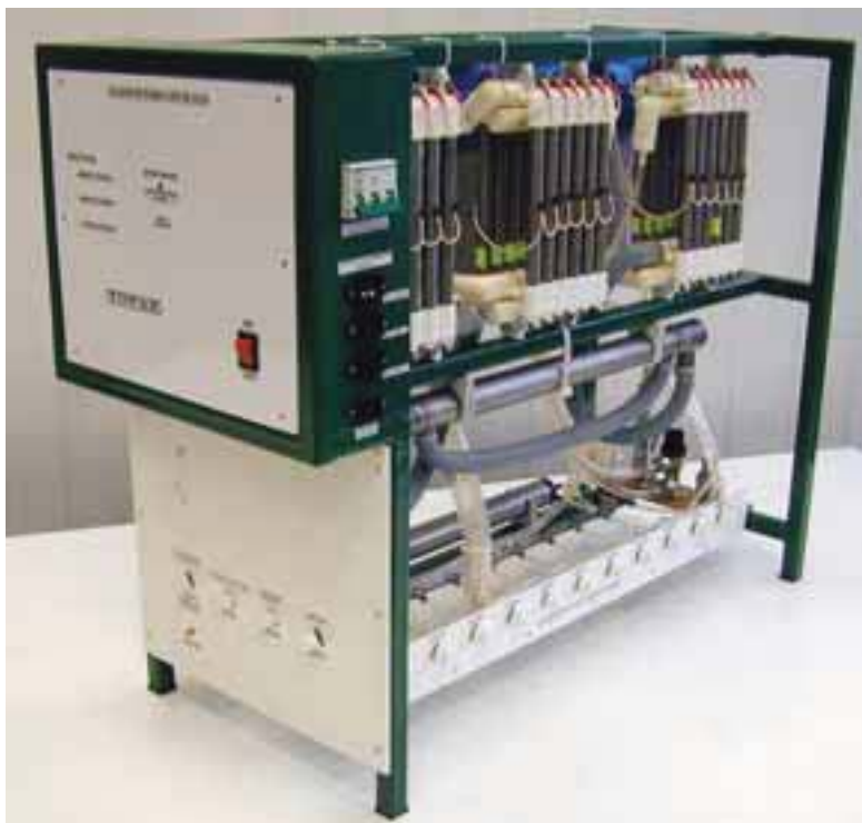
Рис. 2. Установка ИЗУМРУД производительностью 300 литров в час. В установке реализован технологический процесс очистки воды ТОПАЗ. Назначение установки: очистка воды из поверхностных водоисточников в районах чрезвычайных ситуаций. Потребляемая электрическая мощность — 800 Вт. Напряжение на электрохимическом реакторе установки 24 В. Может использоваться в составе подвижного комплекса очистки воды или в стационарных условиях. Питание от источника тока (выпрямителя) 220/30 вольт, либо от аккумуляторов автомобиля. Изготовлена в 2001 году по заказу МО РФ
