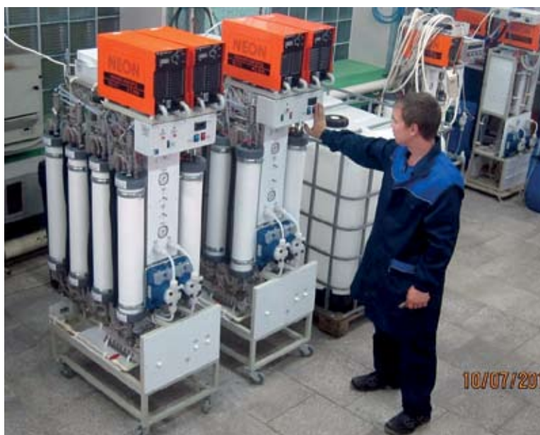
Рис. 7. Установки АКВАХЛОР-2000М производительностью по хлору 2 кг в час с модульными электрохимическими элементами МБ-26Д в диэлектрическом корпусе. Установка АКВАХЛОР-2000М содержит 8 элементов МБ-26 модели 28600М1П4-05. Потребляемая электрическая мощность 8,5 кВт, вес 700 кг.
