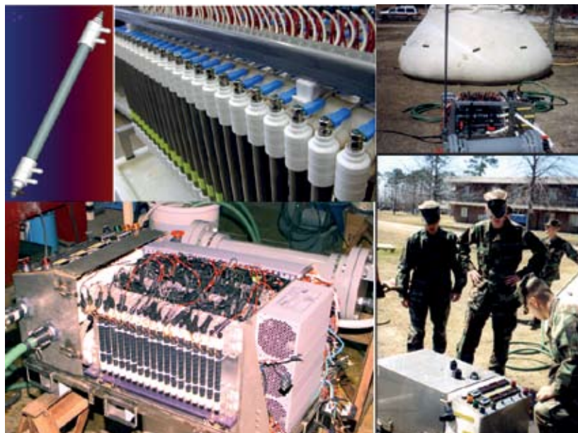
Рис. 4. Реактор РПЭ из 96 элементов ПЭМ-3 (МБ-11) обеспечивает производительность по анолиту 5000 литров в час. На фото морские пехотинцы США испытывают мобильную версию реактора с элементами ПЭМ-3 для получения анолита в полевых условиях. Атланта, 1998.
