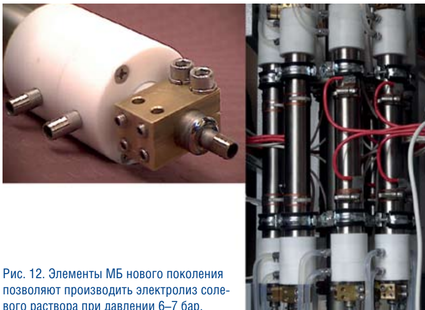
Рис. 11. В 2016 году на предприятии кластера РОСЭЛЕКТРОХИМИНДУСТРИЯ организовано производство электрохимических модульных элементов нового поколения. Производительность по продуктам электролиза новых элементов от 2 до 5 раз выше, чем их предшествующих аналогов. Также организовано производство редукторов влажного хлора, способных работать при давлении на входе до 8 бар.
