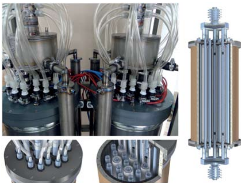
Рис. 6. Модульный электрохимический элемент МБ-26Д модель 28600М7П19-03 в диэлектрическом корпусе (2011–2014 гг). Обозначение элемента МБ в соответствии с ТУ 3614-015-77350578-2016.
