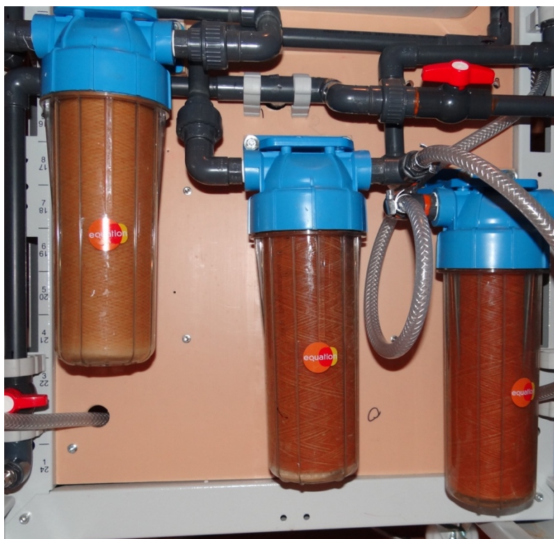
Рис. 6. Внешний вид десятимикронных фильтров экспериментальной установки ИЗУМРУД-УНИВЕРСАЛ-500 после 4 часов работы на пресной артезианской воде с содержанием ионов двухвалентного железа около 4 мг/л.
