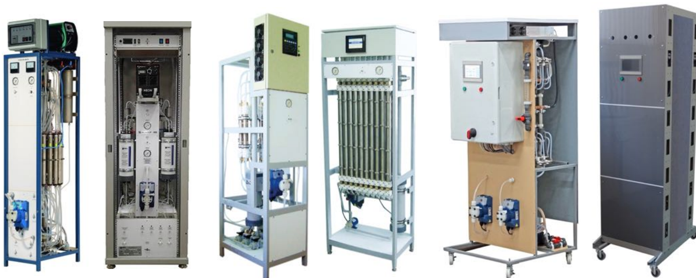
Рис. 10. Установки АКВАХЛОР и ЭКОХЛОР, слева направо: установка АКВАХЛОР-500 (А-500) производительностью 500 граммов хлора в час, нуждается в частой очистке электрохимического реактора соляной кислотой, 2005 год; установка А-500М, 500 граммов хлора в час, снабжена самоочищающимся реактором, ручное управление, 2012 год; установки А-600 и ЭКОХЛОР-3000 (Э-3000) производительностью 600 и 3000 граммов хлора в час, реакторы из элементов МБ нового поколения, полуавтоматическое управление, 2016 год; установки А-800 и Э-4000 производительностью по хлору 800 и 4000 граммов в час, самоочищающиеся реакторы, дистанционный контроль и управление, 2017 год.
