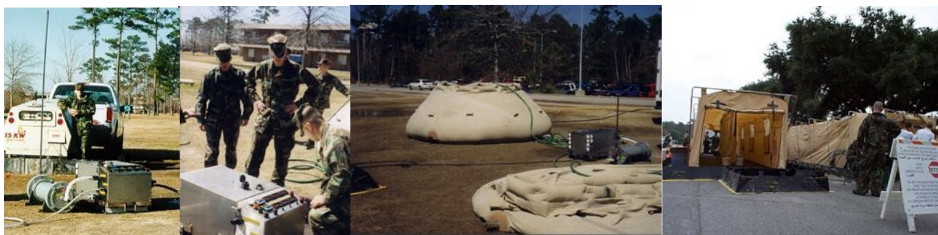
Рис. 2. Морские пехотинцы отрабатывают на полигоне развертывание мобильной установки «Decontamination Generator» с реактором из элементов ПЭМ-3 (МБ-11), заполнение анолитом АНК резиноканевых резервуаров и обработку военнослужащих, их снаряжения и оружия в палатке, где смонтированы душевые системы. Атланта, США, 2001.
