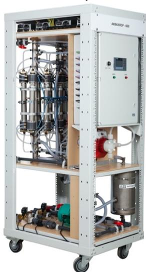
**Рис.6.** Установка СТЭЛ-АНК-СУПЕР-1000 производительно по Анолиту АНК СУПЕР 1000 литров в час. Институт Электрохимических Систем и Технологий. Москва, 2019.
