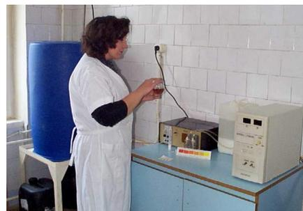
**Рис. 1.** Установка СТЭЛ-10Н-120-01 (модель 80) производительностью 80 л/ч по анолиту АНК. ГKB №52, 1999 г.
