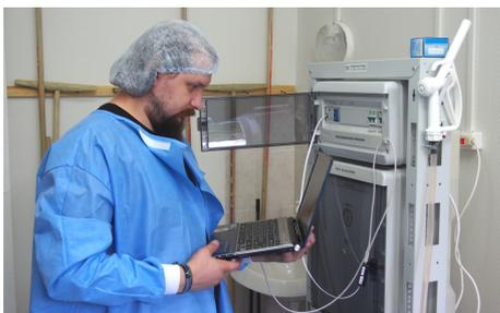
**Рис. 2.** Установка СТЭЛ-АНК-СУПЕР-100 производительностью по Анолиту АНК СУПЕР 100 л/ч, с автоматическими системами поддержания уровня Анолита в накопительной емкости и очистки реактора. ГKB №52, 2016 г.
