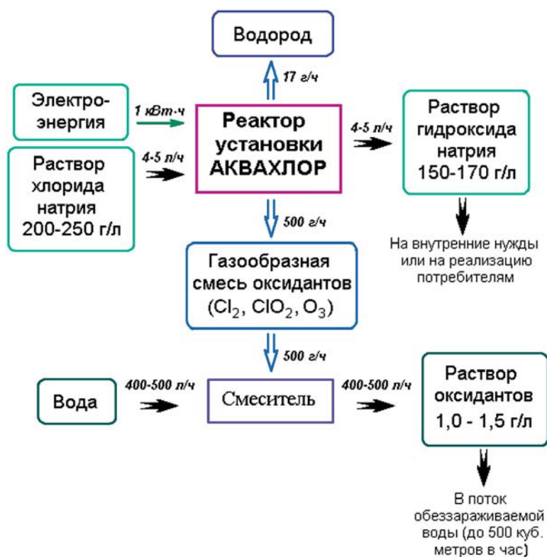
Рис. 2 Принципиальная схема технологического процесса работы установки АК-ВАХЛОР-500 производительностью 500 граммов оксидантов (в эквиваленте хлора) в час
